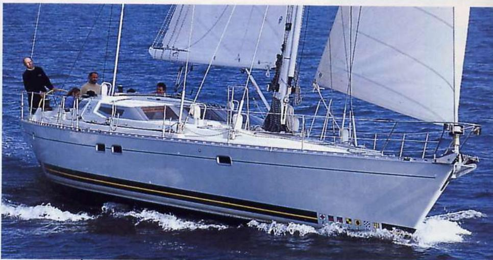
*Il Feeling 546 deve la sua stabilità principalmente alla forma dello scafo, che con i suoi 5,20 m. di larghezza al baglio massimo, permette di tenere a riva molta tela, limitando le manovre di riduzione. E' una caratteristica ideale nell'uso crocieristico.*
