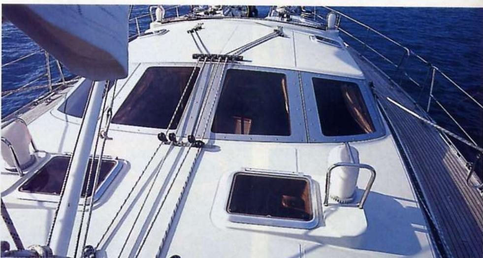
*La particolare tuga a due livelli del Feeling 546 permette grandi altezze interne e consente una ottima luminosità interna. Grazie alla tuga alta anche il pozzetto risulta molto protetto soprattutto in condizioni estreme. Tutte le manovre sono rinviate al pozzetto.*
